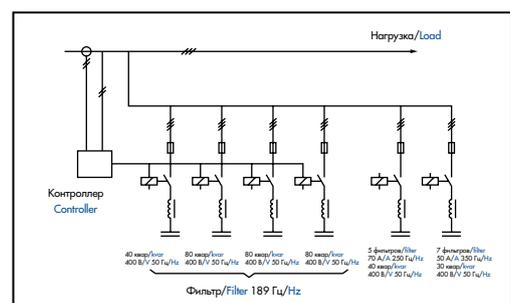
Пример комбинированного фильтра/ Example of combined filter:
