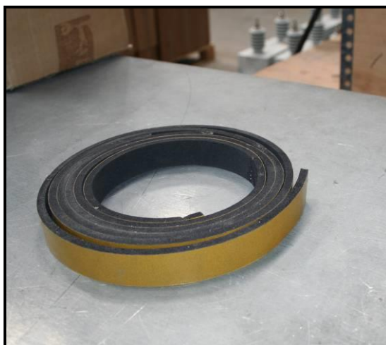
Fig. 9.- Junta de estanqueidad autoadhesiva
