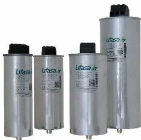
Los condensadores deben instalarse teniendo en cuenta las recomendaciones indicadas en la norma **IEC 60831-1/2**. Son para instalación **interior**, deben estar alejados de fuentes de calor y en lugares bien ventilados. Los condensadores conectados en grupos deberán estar separados unos de otros un **mínimo de 20 mm**. Debe comprobarse que la **Tensión (V)** y la **Frecuencia (Hz)** indicadas en la placa de características sean adecuadas para la red donde va a ser instalado.
